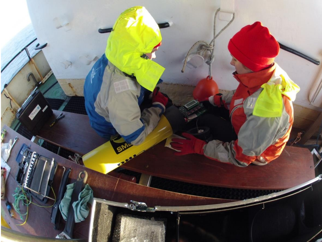
Rys. 10 Ustawianie parametrów rejestrowania danych akustycznych przez urządzenie SM2M przed jego umieszczeniem w wodzie
